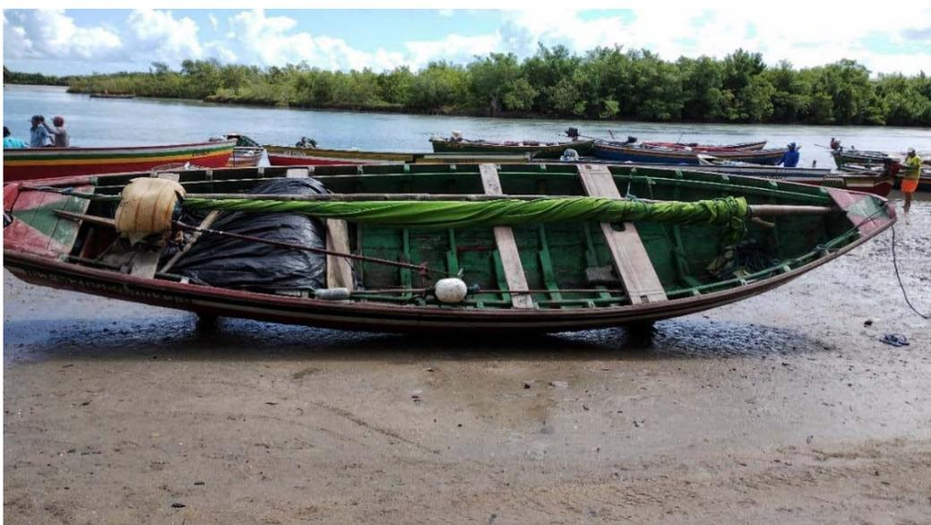
Fonte: Sousa, R. M. L. (Abr/2023). Imagem demonstrando o interior de uma canoa organizada para ir para o mar. Vela de pano enrolada, motor e redes protegidos por uma lona e boias demarcadoras. Pela a ausência de caixa de gelo, essa canoa é de “ída e volta”.
